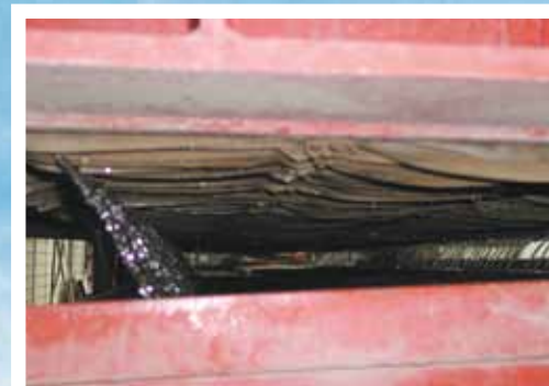
Filtro prensa trabajando
