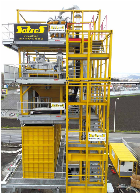
Version superstructure « Le Grand Paris » Dessableur D550-550 550 m 3 /h au primaire 550 m 3 /h au secondaire
